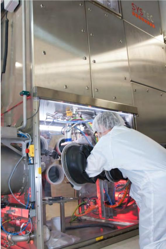
Fraunhofer-Mitarbeiter beim Vorbereiten eines GaN-Kristallzüchtungsexperimentes in der neuen HVPE-Anlage.
