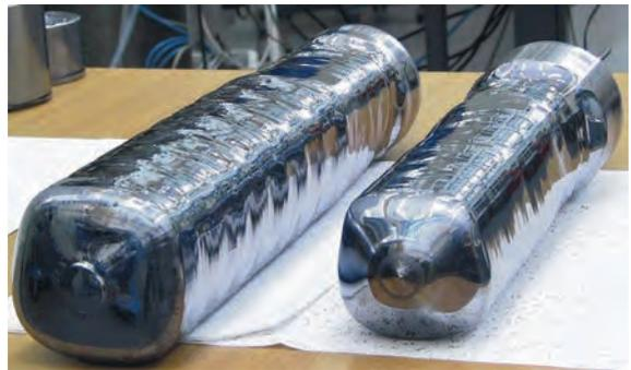
Abb. 3: Im Dezember 2005 erschien MB 82 mit einem Titelbild, das Floating Zone (FZ) Siliciumkristalle mit quadratischem Querschnitt zeigte. Diese wurden am Institut für Kristallzuchtung (IKZ), Berlin zusammen mit einem Industriepartner für kostengünstigere Hochleistungs-Solarzellen entwickelt.
