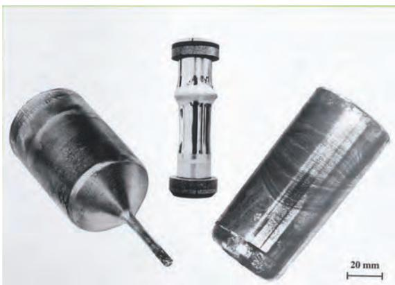
Abb. 2: Das Titelthema von MB 60 (1994) waren diese Kristalle aus dem Erlangerer Kristalllabor: Von links beginnend ist ein nach dem VGF-Verfahren gezüchteter GaAs-Kristall, ein während der Space-lab D2-Mission 1993 nach dem FZ-Verfahren unter Mikrogravitation gezüchteter GaAs-Einkristall sowie ein nach dem VGF-Verfahren hergestellter InP-Kristall abgebildet.
