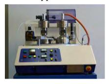
IB 400 Läppmaschinen Tellergrößen von 300 - 400 mm Läppmittelzufuhrsystem Grauguß-Läppteller: glatt, genutet, gerillt
