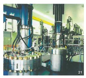
1998 werden die Anlagen für die Massenproduktion von GaAs nach dem Liquid-Encapsulated Czochralski-Verfahren in Betrieb genommen.
