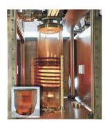
Das Titelbild dieser Ausgabe zeigt einen Aluminiumnitrid-Kristall aus dem IKZ (kleines Bild) vor einem Blick in die dazugehörigen Züchtungsanlage. Der Kristall hat einen Durchmesser von ca. 10 mm und die (0001)-Wachstumsfläche befindet sich oben.
