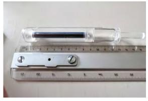
Terrestrische Vergleichsprobe des ParSiWal-Experimentes: Siliziumstab mit dem Partikeldepot (nicht sichtbar), der in einer Quarzglasampulle gehaltert wird. Der Stab mit Ampulle wird in die Spiegelofenanlage ELLI eingebaut.
