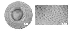
Charakterisierung von Dotierstoffinhomogenitäten mittels Photolumineszenz (links) und mittels chemischen Ätzens (rechts) an hochdotierten Siliciumwafern.
