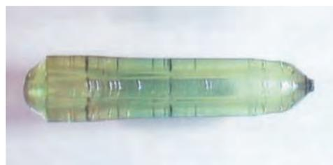
Abb. 12:  $NaVO_3$ -Kristall (Länge = 60 mm, Durchmesser = 15 mm) Foto: IKZ
