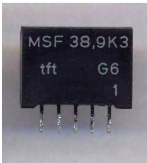
Abb. 14, links: 2"  $\text{LiNbO}_3$ -Kristall aus der Czochralski-Züchtung der Abt. Kristallchemie, rechts: Oberflächenwellenfilter aus der Teltower Produktion auf Basis eines  $\text{LiNbO}_3$ -Kristalls
