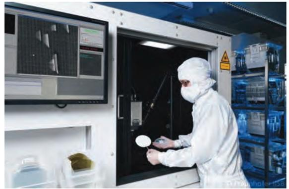
Mit dem neu entwickelten Photolumineszenz-Messsystem lassen sich bereits während der Produktion kleinste Materialfehler in Siliziumkarbid-Wafern nachweisen.
