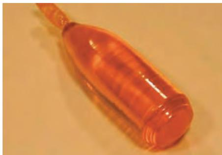
Abb. 23: SmScO<sub>3</sub>-Einkristall (Durchmesser 20 mm, Zylinderlänge 40 mm)
