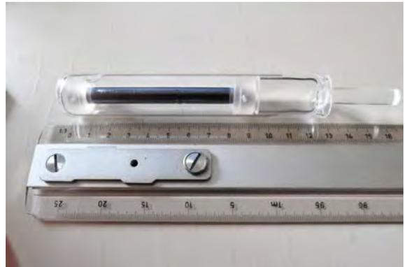
Terrestrische Vergleichsprobe des ParSiWal-Experimentes: Siliziumstab mit dem Partikeldepot (nicht sichtbar), der in einer Quarzglasampulle gehalten wird. Der Stab mit Ampulle wird in eine Ofenanlage eingebaut und unter Schwerelosigkeit bzw. auf der Erde aufgeschmolzen und wieder erstarrt. Bild: Universität Freiburg
