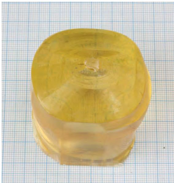
Abb.1: Semiisolierender  $2^* \beta\text{-Ga}_2\text{O}_3$  Kristall (Mg-dotiert), nach der Czochralski-Methode gezüchtet.
