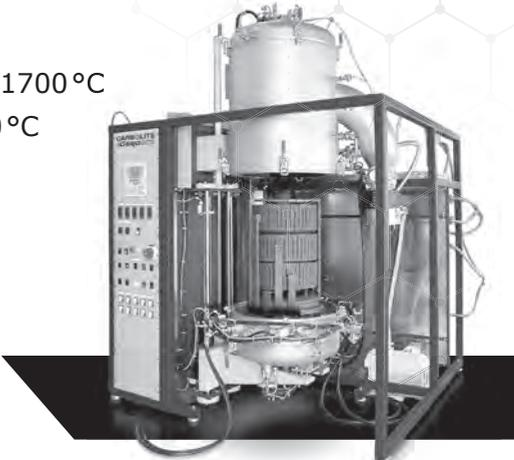
KZV Kristallziehenanlage mit Leistungsregelung für Fluoride nach dem Stockbarger- oder Bridgman-Verfahren bis 1800 °C
