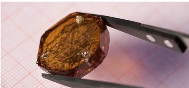
Fig. 1: AlN-Kristall als Halbleitergrundmaterial für leistungselektronische Bauelemente. Bild: Anja Grabinger / Fraunhofer IISB
