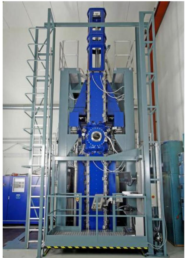
Abb. 3: oben) Foto der Kristallzieherei in Pretzfeld um 1955 mit Anlagen zur Einkristall-Herstellung durch des tiegelfreie Zonenziehen. Quelle: Festschrift anlässlich des 60. Geburtstages von Eberhard Spenke, 1965. unten) Foto einer heutigen Anlage für das tiegelfreie Zonenziehen. Quelle: PVA Crystal Growing Systems GmbH.
