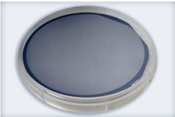
Abb. 2: Dünne kernspinfreie  $^{76}\text{Ge}$ -Schicht, gewachsen auf einem 4-Zoll Durchmesser (001)Si-Wafer in der neuen Molekularstrahlepitaxie-Anlage. (Foto: IKZ)
