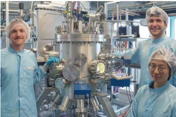
Abb. 1: Neu in Betrieb genommenen Molekularstrahlepitaxie-Anlage zum Wachstum von  $^{28}\text{Si}$ - und  $^{76}\text{Ge}$ -Heterostrukturen, zusammen mit der SiGe-basierten Quantenmaterialien-Gruppe: Dr. Kevin Peter Gradwohl (links), Maximilian Oezkent und Yujia Liu (rechts). (Foto: IKZ)
