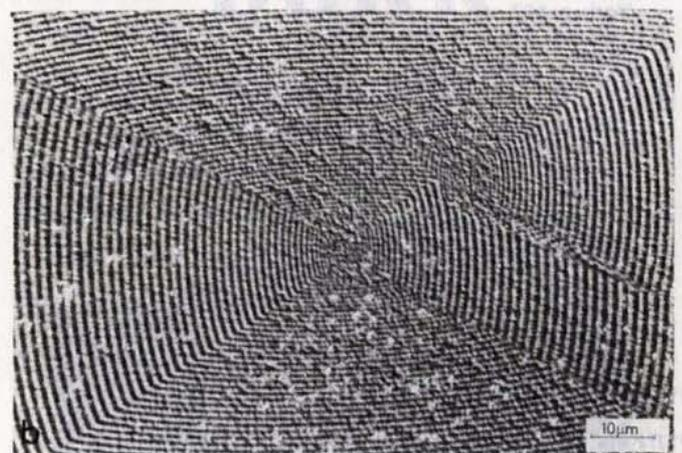
Abb. 13 Facette auf einer GaAs-Flüssigphasenepitaxieschicht, Substrat (100)-orientiert. a) undekoriert, b) mit dekorierten Monostufen
