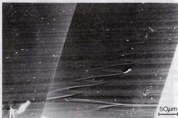
Abb. 12 Oszillierende Talspur mit Terrassenspuren an beiden Talhängen. Die Terrassenspuren sehen aus wie die üblichen Typ I-Striations und lassen sich nur über die oszillierende Talspur identifizieren.
