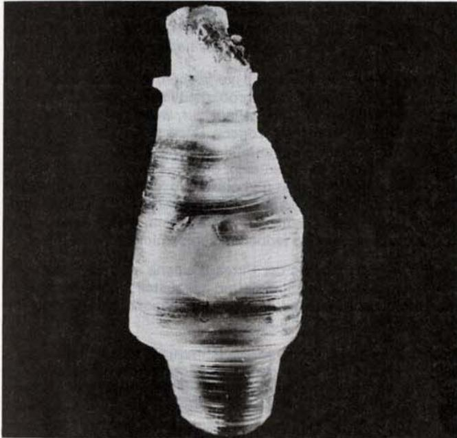
Abb.7: Kaliumchlorid-Einkristall, Länge: 4 cm.
