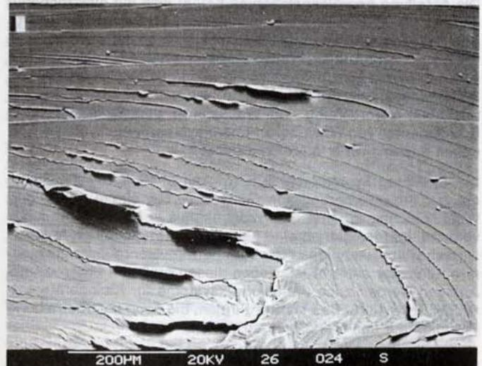
Abb.8b: Ausschnittvergrößerung von Abb.8a oberhalb des Kristallzentrums. Deutlich sind zwei verschiedene, diskordant aufeinanderstehende Scharen von Wachstumslinien zu erkennen.
