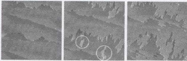
Wachstum von Si auf Si(001) in atomaren Dimensionen, "live" abgebildet mit dem Rastertunnelmikroskop (RTM), Bildgröße 2900 Å, Temperatur 450°C
